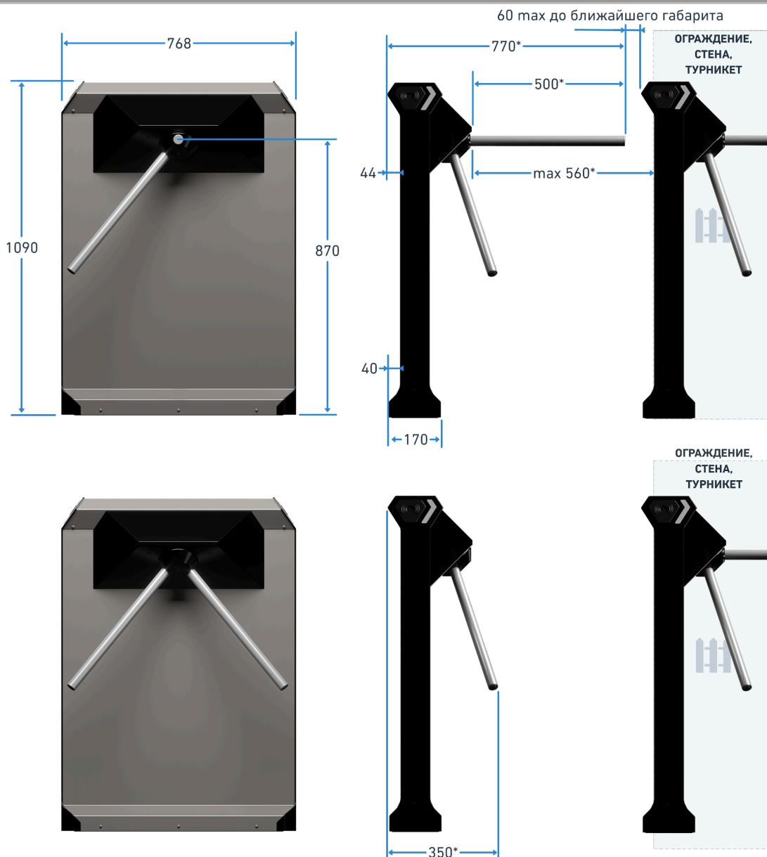
\* По индивидуальному согласованию с производителем, турникет может быть укомплектован специально изготовленными преграждающими планками рабочей длиной более 500 мм до 700 мм.
