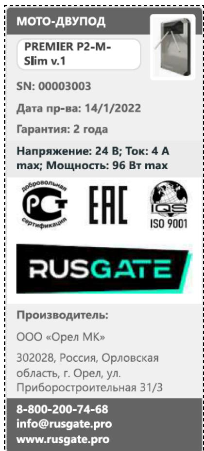
Турникеты имеют физическую маркировку в виде ламинированных этикеток, расположенных внутри корпуса турникета под Передним кожухом. Чтобы считать информацию с этикетки необходимо демонтировать Передний кожух, предварительно отсоединив преграждающие планки. Этикетка имеет вид, приведенный на рисунке.
